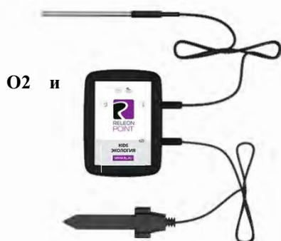
Рис.4. Мультидатчик ЦЛ «Экология» позволяет одновременно измерять: уровень шума; объемную влажность почвы; содержание CO 2 ; освещенность; температуру
