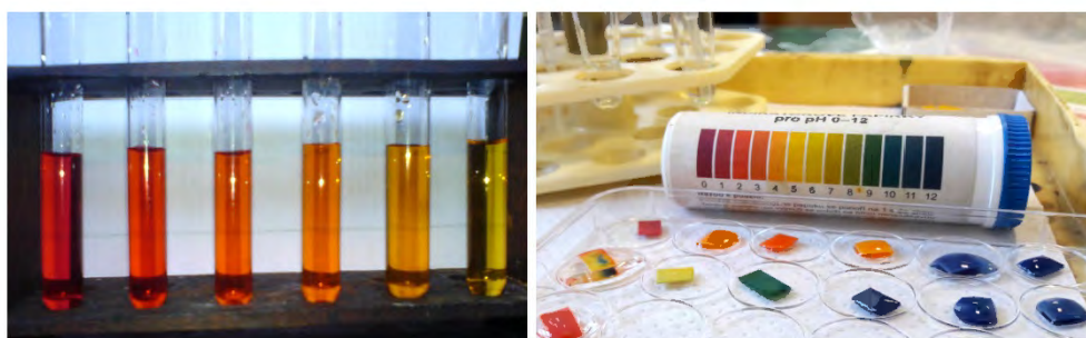
Рис.6. Определение рН раствора с помощью индикаторов
